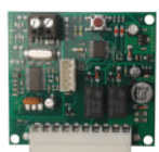
250RXSM2 Récepteur radio à autoapprentissage, 433,92 MHz, bicanal embrochable (mémoire 14 codes)
